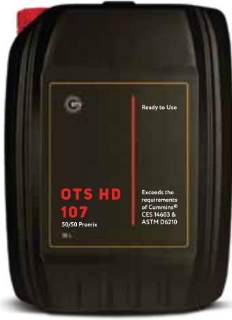
**OTS HD 107** – карбоксилатный антифриз на основе МЭГ для тяжело нагруженных дизельных двигателей, для которых рекомендован ОАТ-антифриз с содержанием нитритов и молибдатов не менее 780 ppm согласно ASTM D6210. Отличается дополнительной защитой мокрой гильзы цилиндра при максимально увеличенном сроке службы: 1 600 000 км, 20 000 моточасов или 8 лет, в зависимости от того, что наступит быстрее. Данный антифриз полностью соответствует стандарту ASTM D6210 дизельных двигателей тяжелой техники.
